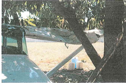
1.12.1 Destrucción total del ala izquierda por golpe directo contra las ramas de un árbol.
