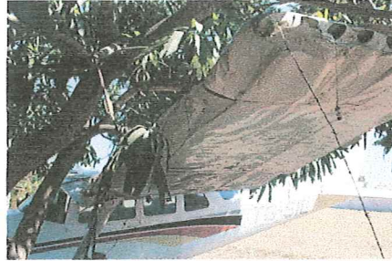
1.12.1 Destrucción total del ala izquierda por golpe directo contra las ramas de un árbol.
