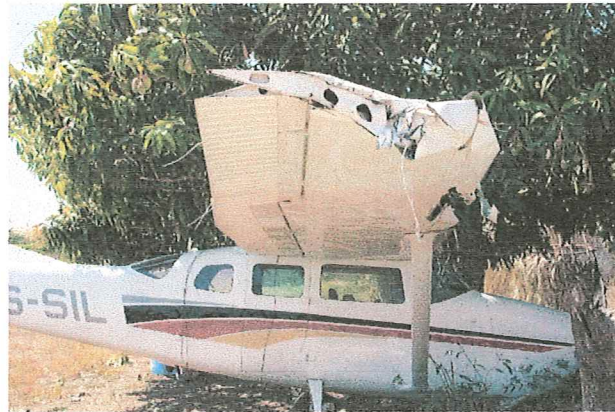
1.12.1 Destrucción total del ala izquierda por golpe directo contra las ramas de un árbol.
