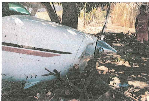
1.12.4 Pérdida total del cobertor inferior del motor.
