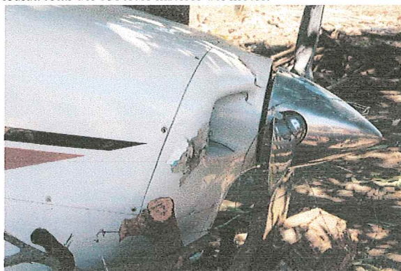
1.12.5 Sección frontal de los cobertores del motor, rotos.
